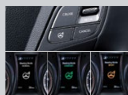
Изменяемое усилие на руле Flex Steer.
