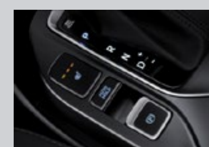
Электрический стояночный тормоз с автоматическим удержанием.
