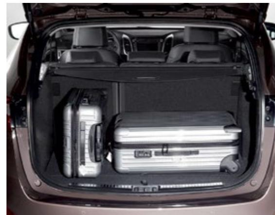
Минимальный объем багажного отсека универсала i30 составляет 528 литров, при этом задние спинки сидений при трансформации салона образуют абсолютно ровный пол и общий объем 1642 литра.
