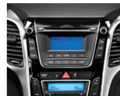
Аудиосистема. Для лучшего звучания аудиосистема оборудована шестью динамиками, включая два «твиттера», которые установлены в панели передних дверей.
