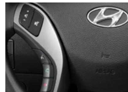
Управление аудиосистемой осуществляется кнопками на левой части руля. Здесь же могут быть расположены клавиши управления Bluetooth™ с системой распознавания голосовых команд (опция).
