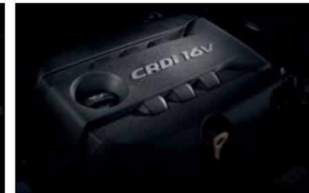
**Дизельный двигатель** объемом 1,6 л при максимальной мощности 127 л.с. выдает внушительные 260 Нм крутящего момента, обеспечивая серьезную экономию топлива. За счёт применения алюминиевых сплавов в конструкции существенно снижен уровень шума и вибрации. Доступен для кузова универсал.
