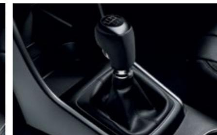
**6-ступенчатая механическая трансмиссия** доступна с бензиновыми двигателями i30. Для большей экономии топлива и уменьшения выбросов CO<sub>2</sub> на панель приборов был добавлен индикатор, который указывает на идеальный момент для переключения следующей передачи. Система помощи при старте в горку (опция) не позволяет машине откатываться назад, когда вы трогаетесь на уклоне. Рукоятка рычага переключения передач отделана кожей.
