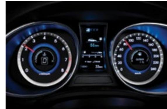
Более четкая и технологичная панель приборов **Supervision** с **цветным TFT дисплеем 4,2 дюйма** облегчает считывание информации и делает салон более нарядным.
