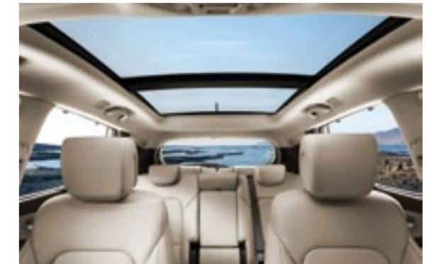
**Панорамная крыша** Grand Santa Fe оснащена шторкой с электроприводом и благодаря отсутствию центральной перегородки пропускает гораздо больше света.
